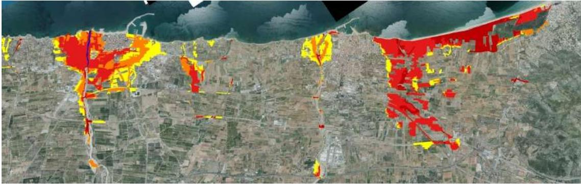
Fuente: Observatorio Sostenibilidad. 2019. Elaboración propia a partir de MITECO y ortofoto IGN. Representación de la incidencia de las láminas de inundación sobre la superficie artificial según SIOSE 2014. En rojo oscuro incidencia de la lámina de 10 años; en rojo claro, 50 años, en naranja, 100 años; y en amarillo 500 años. En azul los principales cauces. (el oeste se representa hacia arriba)
