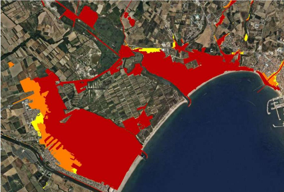
Fuente. Elaboración propia a partir de MITECO y ortofoto IGN. Representación de la incidencia de las láminas de inundación sobre la superficie artificial según SIOSE 2014. En rojo oscuro incidencia de la lámina de 10 años; en rojo claro, 100 años; y en amarillo 500 años.
